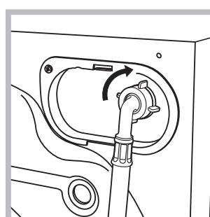
2. Pripojte prítokovú hadicu k práčke, jej zaskrutkováním k príslušnej prípojke na vodu, umiestnejnej vpravo hore (viď obrázok).
